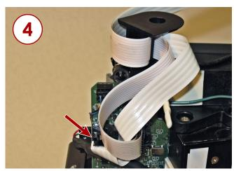
Figure 20. Loop & Insert Power Cable Into J2
